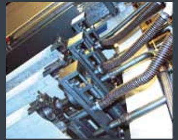
Wemhöner Mehretagen-Durchlaufpressen werden über- oder nebeneinander installiert. Die Beschickung und Entleerung erfolgt vollautomatisch. Der Teiletransport innerhalb der Press-Etagen wird über linear geführte Folienbänder gesichert. Die oberhalb der Pressplatten angeordneten Zylinder gewähren eine gleichmäßige Druckverteilung von  $10 \text{ N/m}^2$  bis  $200 \text{ N/cm}^2$ . Fluide Medien wie Thermoöl oder Heißwasser temperieren die Heizplatten auf bis zu  $130^\circ\text{C}$ .
