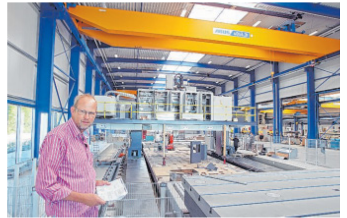
Ganz modern: Die neue Fräsmaschine kann Bauteile von bis zu 50 Tonne Gewicht bearbeiten, das weiß Mitarbeiter Bernhard Löwe.
