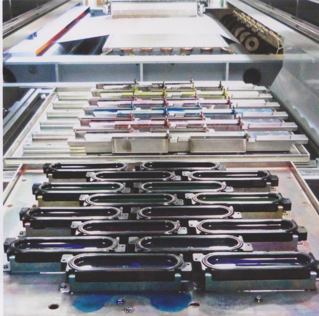
Immer sauber bleiben: Vorne der „Abstellplatz“ (dunkel) für die Druckköpfe, dahinter die Reinigungsstation (bunt)
