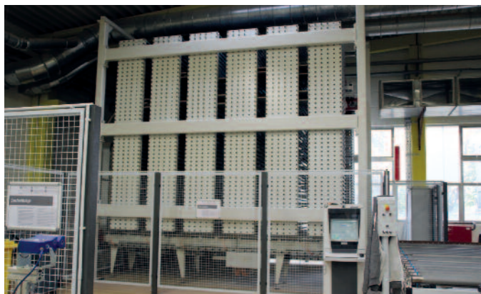
>Unten links: Der Sortierspeicher nach dem Plattenzuschnitt. Mitte: Chargenbildung für das Verpressen. Rechts: Der Spritzroboter benetzt erst die Kanten, dann die Flächen und noch einmal die Kanten.
